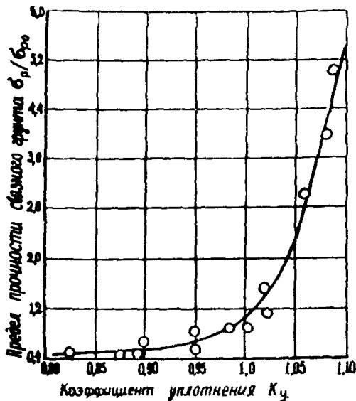
Зависимость относительной прочности связного грунта  $\sigma_p/\sigma_{p0}$  и соответственно требуемых контактных давлений рабочих органов грунтоуплотняющих машин от его плотности ( $\sigma_{p0}$  — предел прочности при  $K_y = 1$ )
