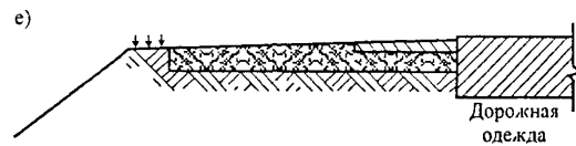
Рис. 2. Конструктивные решения по укреплению обочин
