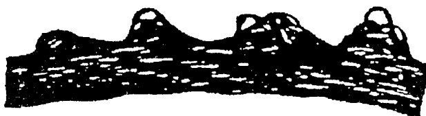
Рис 11 Выдавливание проволок прядей а — в одной пряди, б — в нескольких прядях
