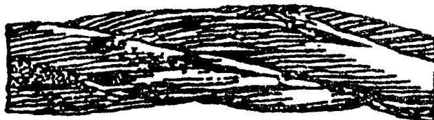
Рис 1. Обрывы и смещения проволок каната крестовой свивки
