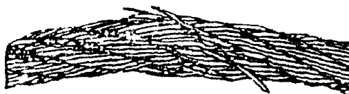
Рис 2 Сочетание обрывов проволок с их износом; а – в канате крестовой свивки, б – в канате односторонней свивки
