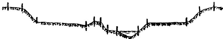
Рис. 7. Разбивка живого сечения
