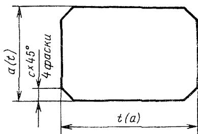
Рабочая часть непроходных калибров должна иметь сечение и исполнительные размеры, соответствующие указанным на чертеже и в табл. 1 (графы 1, 3, 4) и 2.
