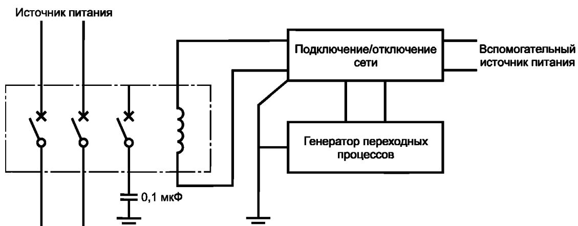
Рисунок 7 — Испытательная цепь для проверки влияния электромагнитных помех
