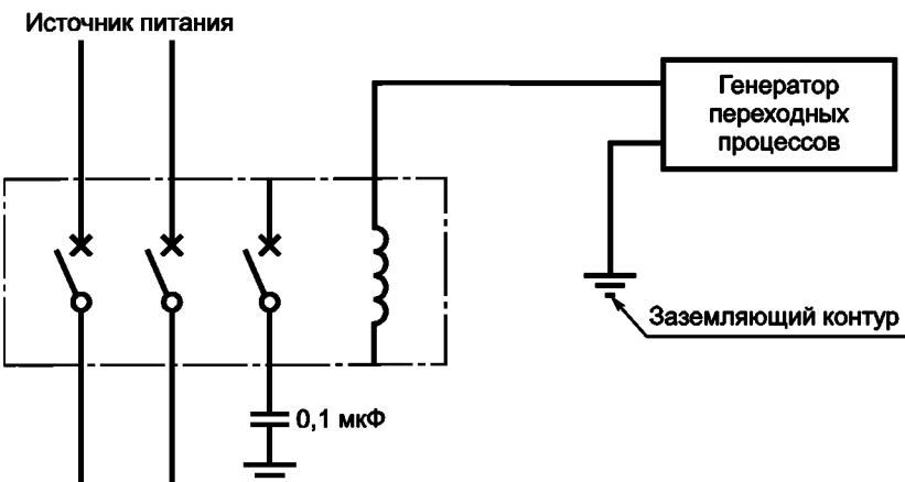
Рисунок 6 — Испытательная цепь для проверки влияния
