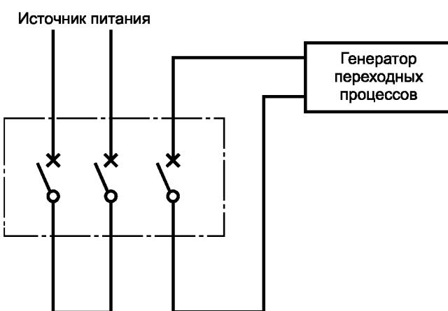
Рисунок 5 — Испытательная цепь для проверки влияния электромагнитных помех в главной цепи (дифференциальный тип)
