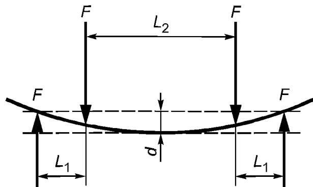
$L_1$  — расстояние между внешней опорой и ближайшей к ней внутренней опорой;  $L_2$  — расстояние между двумя внутренними опорами;  $F$  — сила (реакция опоры), возникающая в каждой из опор, направленная перпендикулярно к испытуемому образцу в исходном состоянии (на большинстве приборов измеряют  $2F$ );  $d$  — изгиб (стрела прогиба) посередине испытуемого образца между внутренними опорами, измеренный от линии, проходящей через точки контакта внутренних опор с испытуемым образцом
