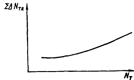
Рис.16. Зависимость суммарных потерь турбоагрегата от электрической мощности
