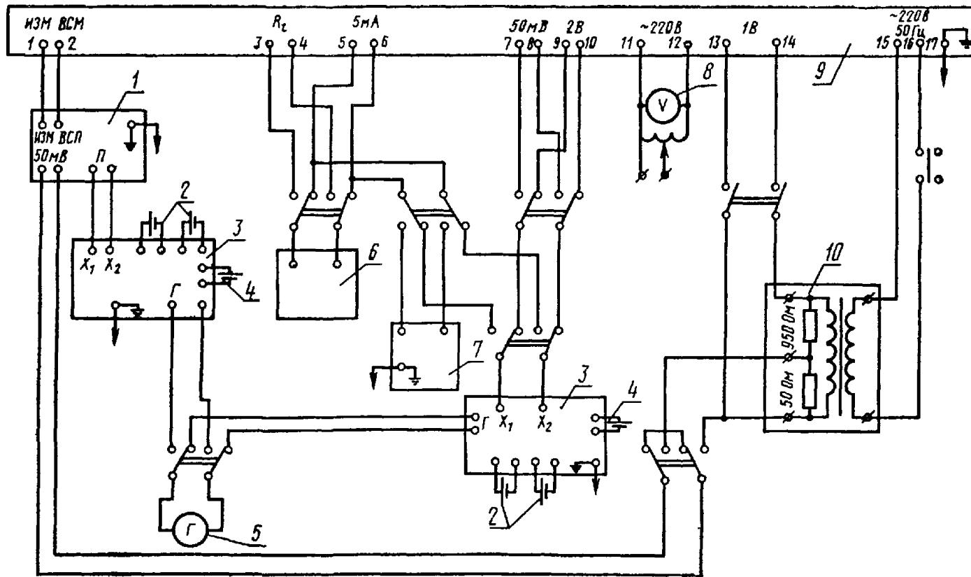
Схема установки для поверки рН-метров:
