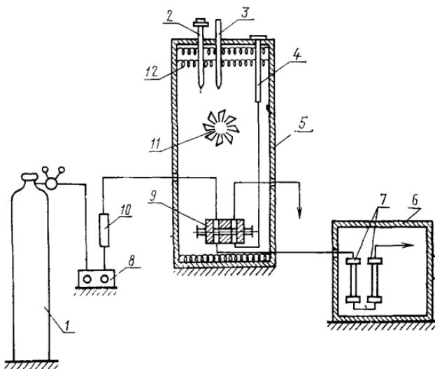
Газ-носитель гелий из баллона 1 через блок подготовки газов 8 и ловушку 10, заполненную ангидроном, поступает в микродозатор 9, а затем в трубку 7, заполненные активированным углем. Четыреххлористый углерод из напорной склянки 4 поступает в микродозатор снизу вверх. Микродозатор и напорная склянка помещены в воздушный термостат 5.
