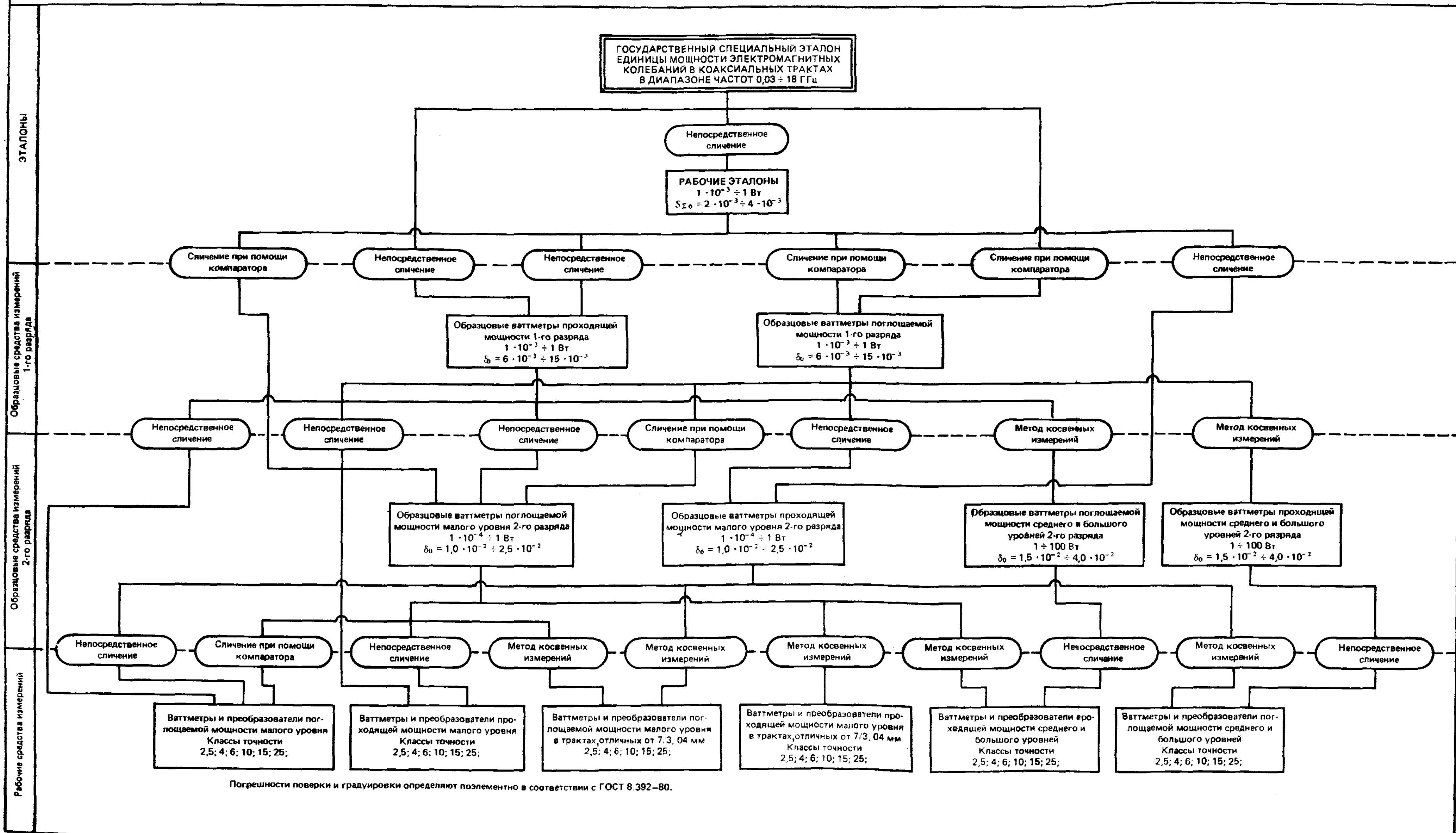
Погрешности поверки и градуировки определяют поэлементно в соответствии с ГОСТ 8.392-80.
