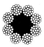
Настоящий стандарт распространяется на стальные канаты (тросы) с линейным касанием проволок в прядях и с проволоками заполнения, типа ЛК-З, с одним органическим сердечником.
