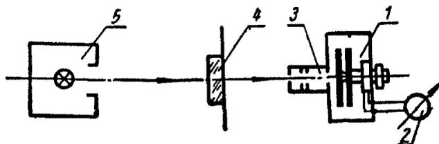
1 — колориметрическая головка; 2 — гальванометр;
