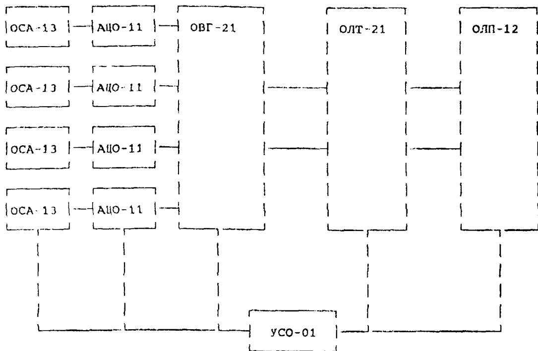
ОСА-13 - комплекс согласующего оборудования межстанционных соединительных линий
