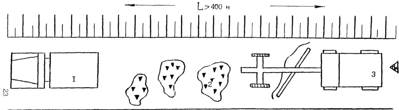
1 – автомобиль самосвал; 2 – материал; 3 – автогрейдер ДЗ 99-1-4; ДЗ-61; ДЗ-61А.
