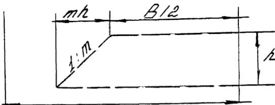
2.4. Забой для грейдер-элеватора целесообразно подготавливать двумя-тремя зарезаниями автогрейдера по одному следу для образования уступа высотой 0,3-0,35м.
