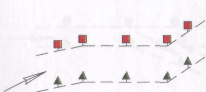
Рисунок Б.1 - Двухстороннее ограждение канала (фарватера)
