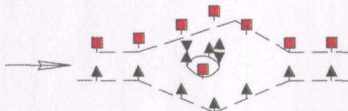
Рисунок Б.8 - Канал (фарватер) разделяется опасностью на два, затем снова соединяется
