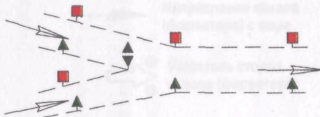
Рисунок Б.7 - Соединение равнозначных каналов (фарватеров)
