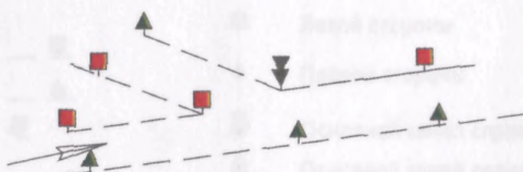
Рисунок Б.5 - Разделение равнозначных каналов (фарватеров) с сохранением прямого хода
