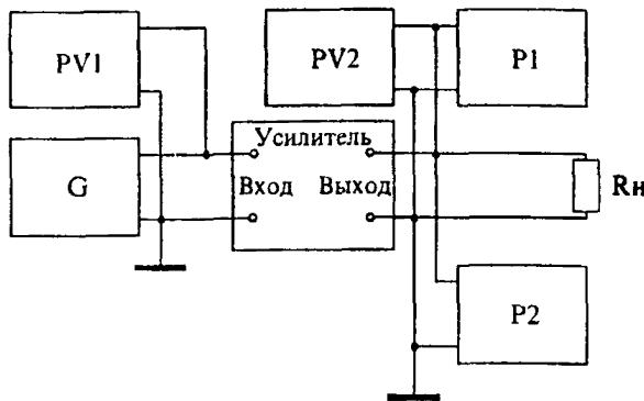
**G** - генератор сигналов низкочастотный,
