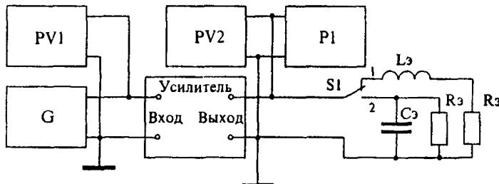
$G$  - генератор сигналов низкочастотный,
