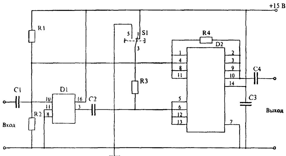
C1 ..C4 - конденсатор K73-17-63 В-1  $\mu$ Ф $\pm$ 10%,
