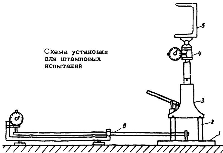
30 сек. По истечении этого времени и через 30 сек после снятия нагрузки по индикатору снимают отсчеты. По разности отсчетов определяют упругую деформацию конструктивного слоя.
