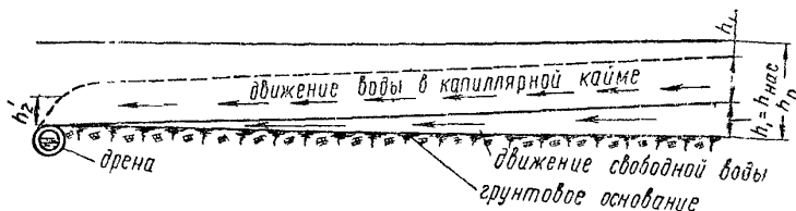
Рис 17 Расчетная схема движения воды в дренирующем слое
