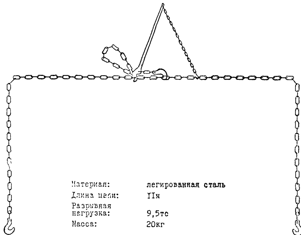
Рис. П.4.5. Цепной пояс с натяжным рычагом
