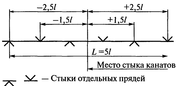
Рис. 46. Схема счалки канатов:
