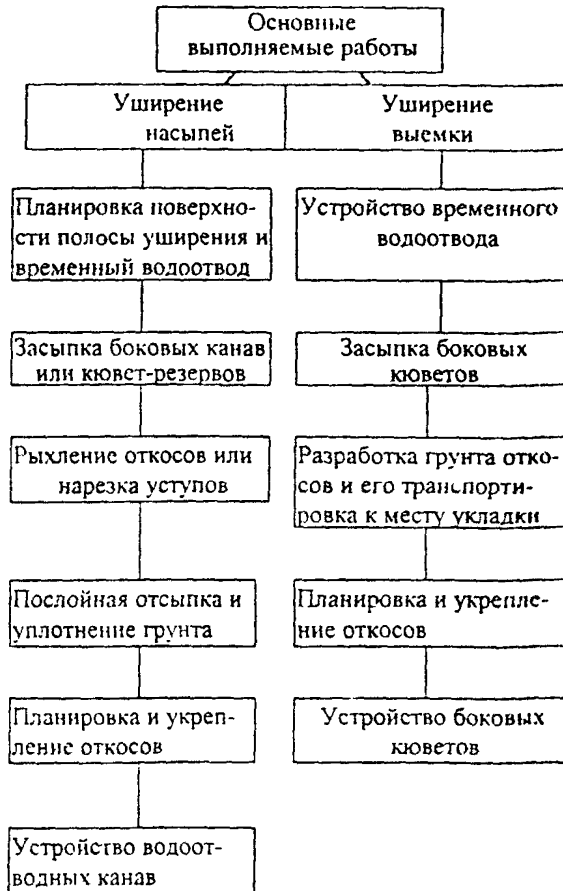
Рис 3. Последовательность работ при уширении земляного полотна
