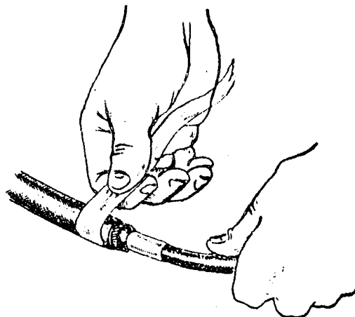
Рис. 4. Наложение поясков савилена при герметизации внешней полиэтиленовой оболочки
