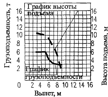
График грузоподъемности и высоты подъема для крана KC-3571, L_{стр.}=10\text{ м}
