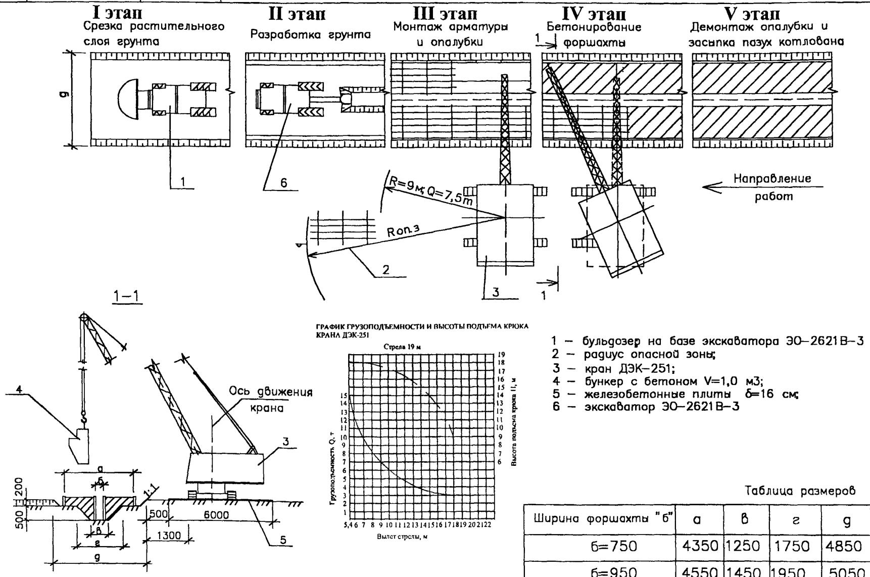
Рисунок 1 — Схема устройства форшахты
