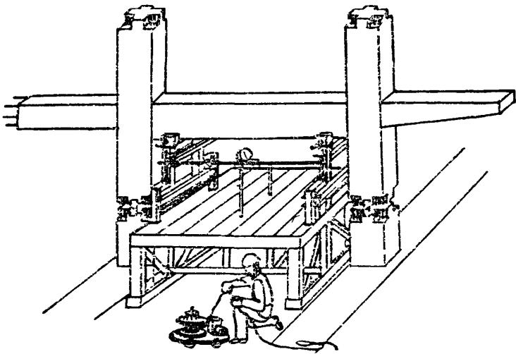
**3 ЭЛЕКТРОШЛАКОВАЯ СВАРКА ВЕРТИКАЛЬНЫХ СТЕРЖНЕЙ; 25 мин; Э<sub>1</sub>, Э<sub>2</sub>, М; сварочное оборудование**
