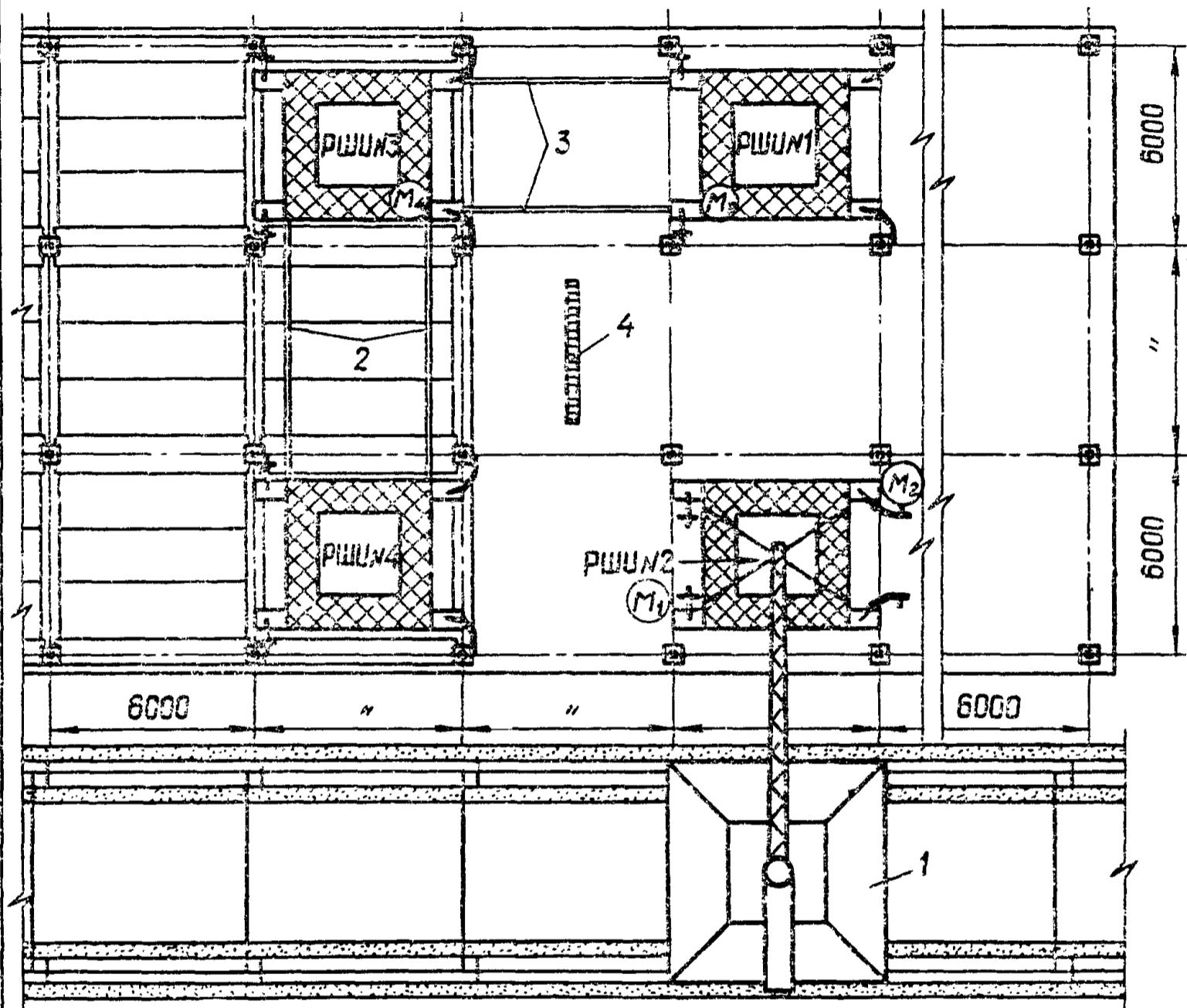
(M<sub>1</sub>), (M<sub>2</sub>), (M<sub>3</sub>), (M<sub>4</sub>) - рабочие места монтажников
