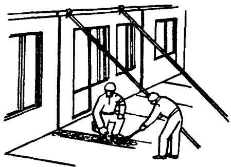
Монтажник М<sub>2</sub> лопатой подает на место установки блока раствор, а монтажник М<sub>1</sub> кельмой разравнивает его между каналами нижнеустановленного блока слоем на 5-8 мм выше установленных ранее маяков, с отступом от граней каналов в 15-20 мм
