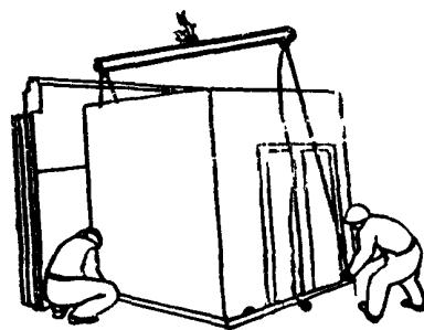
и устранили отклонения путем рихтовки кабины помами и подсыпки песка. Затем монтажники открывают предохранительные устройства и поочередно освобождают карабины стропов траверсы из монтажных петель кабины. Машинист крана поднимает траверсу, а монтажники еще раз проверяют правильность установки кабины при помощи отвеса-рейки
