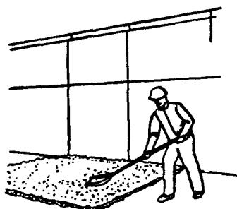
Монтажники  $M_1$  и  $M_2$  лопатами набрасывают необходимое количество песка на место установки кабины, а затем разравнивают его до проектной отметки
