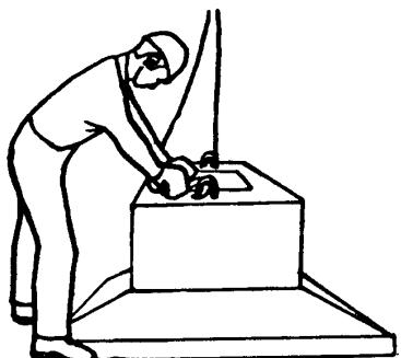
Монтажник  $M_2$  цепляет два крюка четырехветвевого стропа за монтажные петли фундамента. Убедившись в надежности строповки, он отходит на безопасное расстояние и подает команду машинисту крана приподнять фундамент
