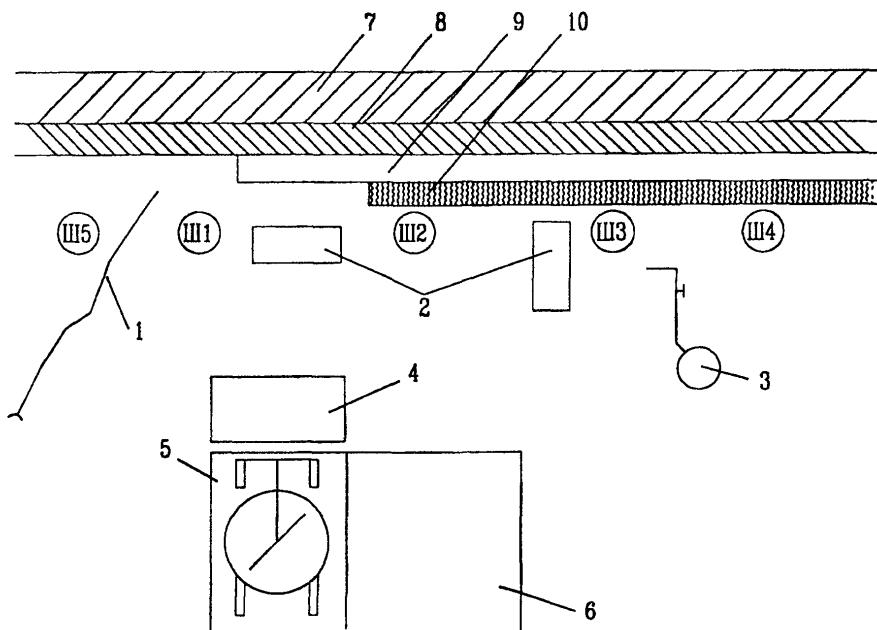
1 — водопроводный шланг; 2 — противни; 3 — краскопульт; 4 — приемный ящик; 5 — растворомешалка; 6 — ящик для цемента; 7 — стена; 8 — обрызг из цементно-песчаного раствора; 9 — слой грунта из цементно-песчаного раствора; 10 — накрывочный слой из декоративного раствора.
