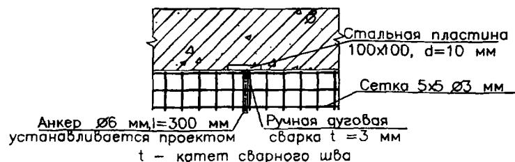
Рисунок 2 – Схема расстановки закладных деталей, устройства металлических анкеров
