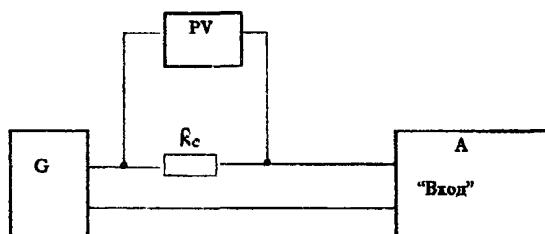
G - генератор сигналов низкочастотный;
