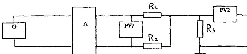
G - генератор сигналов низкочастотный;
