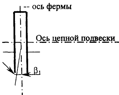
Рис 2.6. Схема для определения угла скольжения ветра относительно ригеля.
