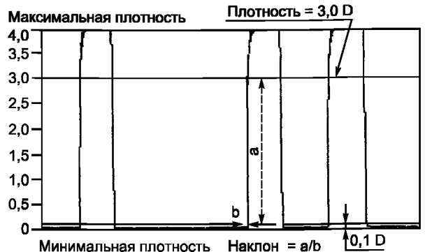
Тангенс угла наклона = a/b Рисунок А.2 — Измерение тангенса угла наклона
