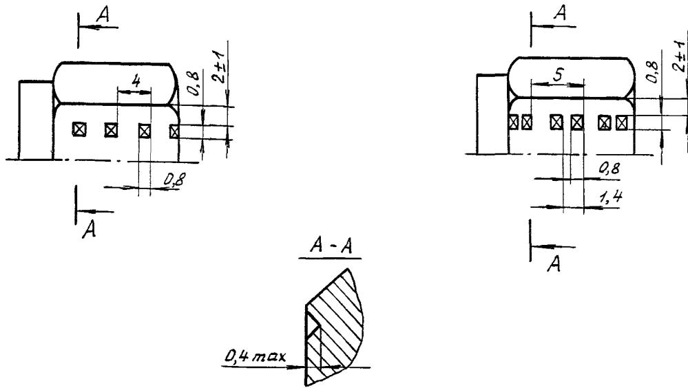
Размеры для накатывания маркировочных знаков обеспечиваются инструментом.
