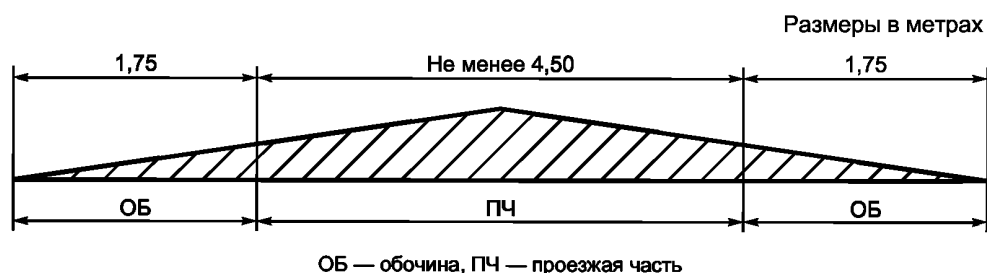
Рисунок 12 — Поперечные профили автомобильных дорог категории V
