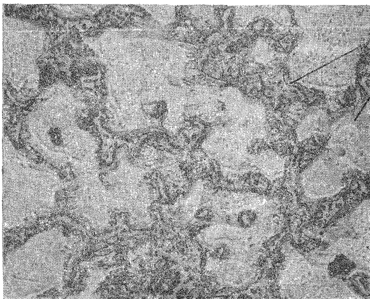
Рис 1. Сплав МЛ5, МЛ5лч, МЛ5он. Литой Травление в реак- тиве № 2. а — \times 100 ; б — \times 500
