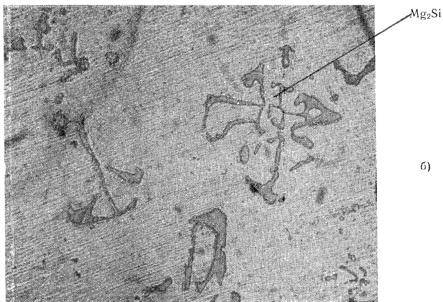
Рис. 3 Сплав МЛ5, МЛ5пч, МЛ5оп. Состояние Т4 (Закаленные) а — травление в реактиве № 1, \times 200 ; б — без травления, \times 500
