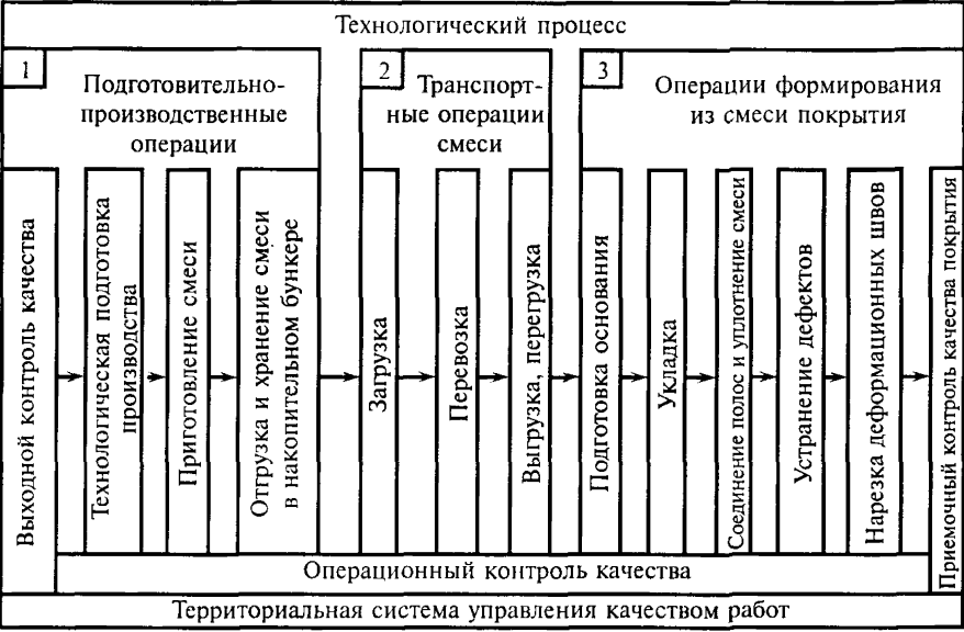
Рис. 1.2. Структурная схема технологического процесса строительства асфальто-бетонного покрытия
