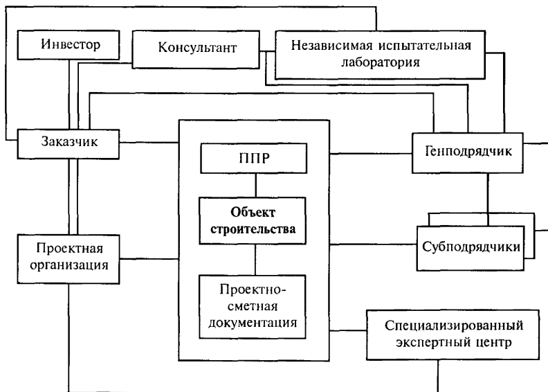
Рис. 1.1. Структурная схема взаимодействия участников инвестиционного процесса при управлении качеством дорожных работ
