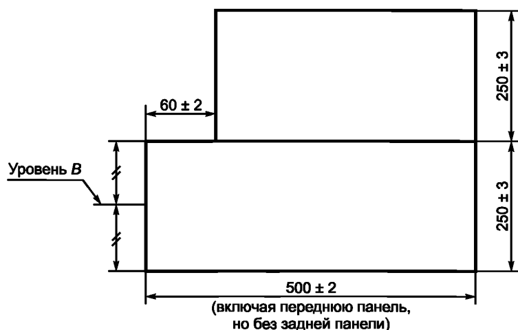
Рисунок 2 — Размеры ударного элемента
