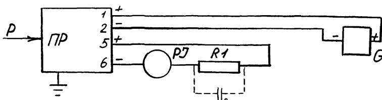
а) – подключение образцового сопротивления нагрузки к клеммам 5 и 6.
