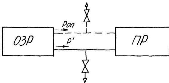
ОЗР – образцовый задатчик давления и (или) разряжения (например, "Воздух-250");
