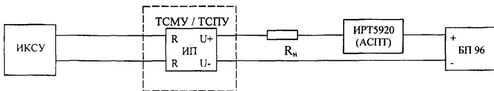
Термопреобразователи с унифицированным выходным сигналом (0...5) мА
