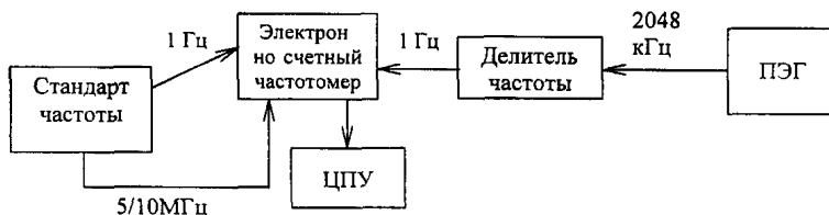
Рисунок 1 - Схема измерений относительной погрешности частоты фазово-временным методом с помощью перевозимого стандарта частоты
