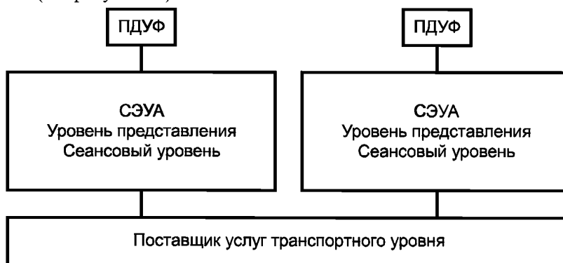
Рисунок 10 — Модель использования поддерживающих протоколов функцией ПДУФ
