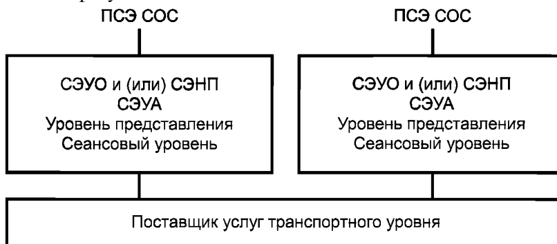
Рисунок 6 — Модель использования поддерживающих протоколов системой обработки сообщений
