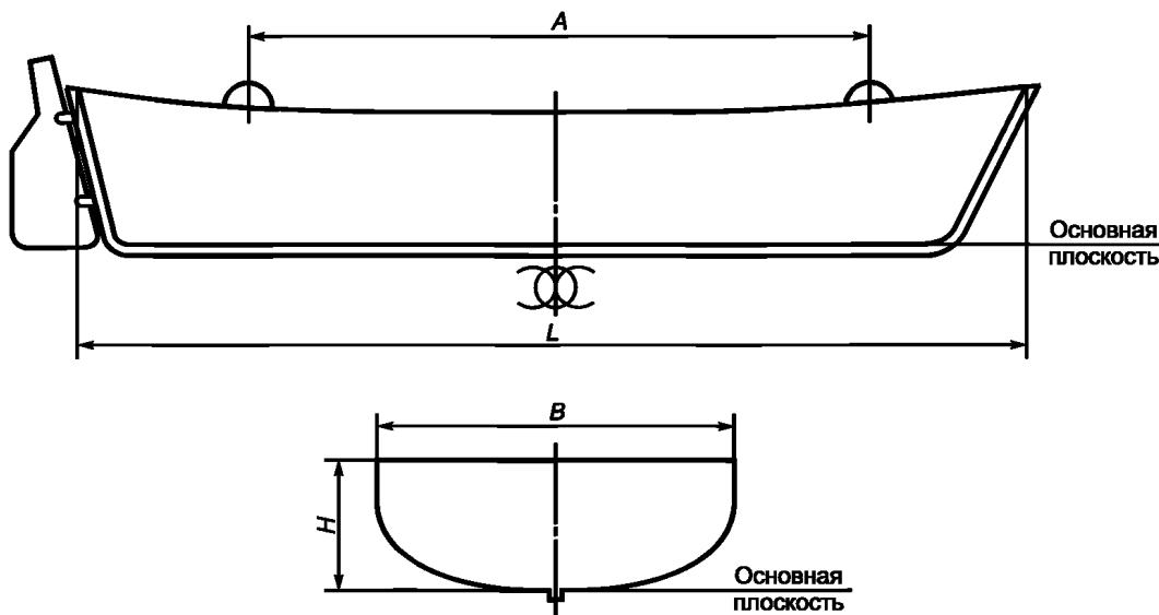
*L* — расстояние между проекциями на основную плоскость точек пересечения наружной поверхности обшивки с форштевнем и ахтерштевнем (транцем); *B* — наибольшая ширина между наружными поверхностями обшивки; *H* — высота борта, измеренная вертикально от основной плоскости до нижней кромки планшира; *A* — расстояние между осевыми линиями подъемных гаков
