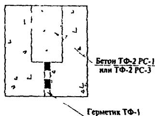
Рис. 16. Заделка трещин в бетонных и железобетонных конструкциях
