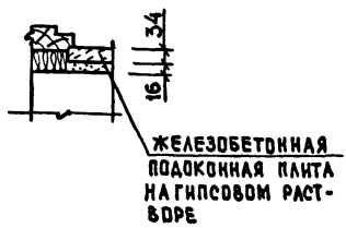
ФРАГМЕНТ УЗЛА 25 ПРИ УСТАНОВКЕ ЖЕЛЕЗОБЕТОННОЙ ПОДКОННОЙ ПАНТЫ
