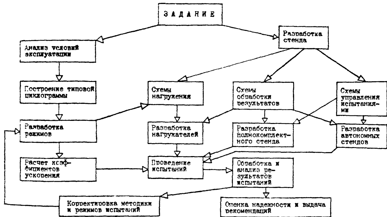
Рис.2. Примерная схема организации стендовых испытаний на надежность
