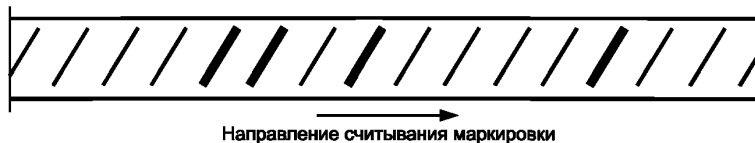
Рисунок 2 — Пример прокатной маркировки предприятия-изготовителя под номером 14
